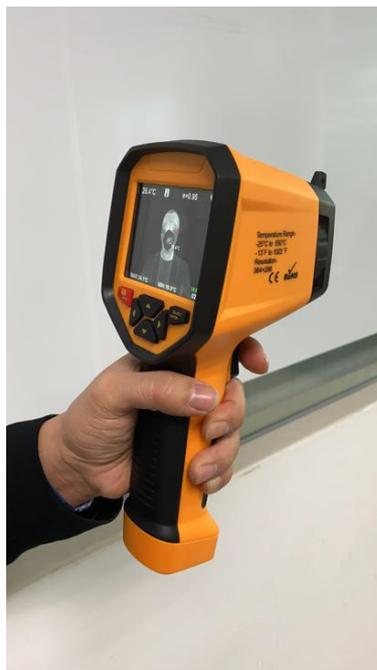
FS-607 是一款手持式红外测温热像仪，红外探测器分辨率达 384x288 3.5 寸触摸屏，该仪器采用符合人体工程学的全新设计理念，并达到了 2 米跌落的超高防护等级。
